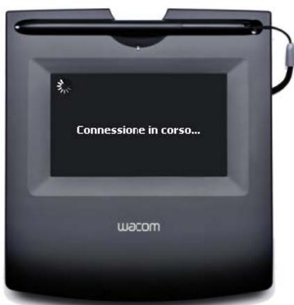
Sul display, che sino ad ora era semplicemente illuminato in maniera neutra, comparirà la sezione del documento identificato dall'operatore. A questo punto il firmatario non dovrà fare altro che impugnare la penna collegata al dispositivo e firmare sul display (fig. sotto).
